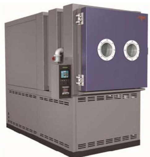
Термовлагодбарокамеры предназначены для воссоздания условий эксплуатации авионики и аэрокосмической техники. Обеспечивают одновременное воздействие на образец температуры и влажности, а также пониженного давления до 0,5 кПа.
